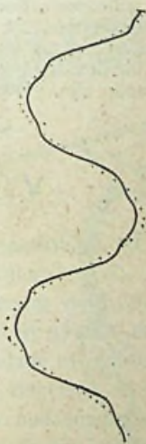
Fig. 10. Wisselstroomkromme, die door aanwezigheid der 3de harmonische is vervormd, vergeleken met de sinus-kromme (gestippeld).
