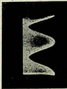
Fig. 5. Beeld van 50-periodigen wisselstroom met onze glimlamp-oscillograaf.
